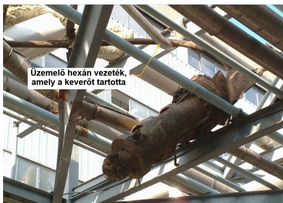
3. ábra: A tartályból kirepülő keverőelem, melyet a csőhídon egy működő hexán vezeték tartott meg
