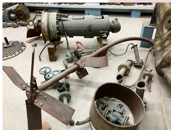
5. ábra: A Meghibásodási Archívumban található R-600 jelű tartály sérült szerkezeti elemei
