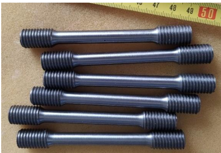
A szakítóvizsgálati jellemzők meghatározására kiküldött próbatestkészlet
