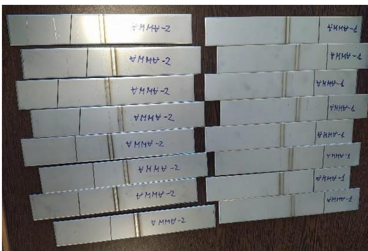
A varrat makroszkópos és mikroszkópos vizsgálatára kiküldött minták
