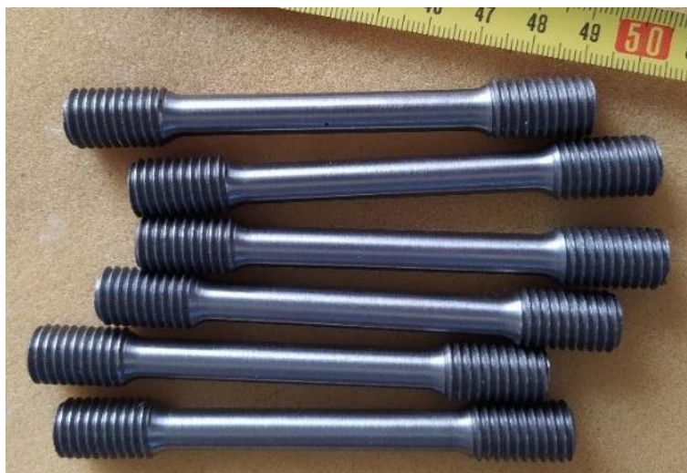
A szakítóvizsgálati jellemzők meghatározására kiküldött próbatestkészlet
